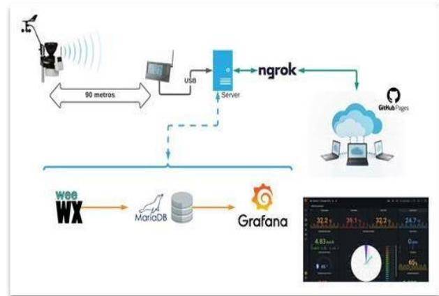
Fig. 1 Diagrama general de la plataforma diseñada
